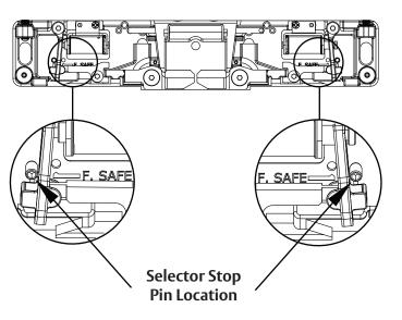
**Diagram 5: FAIL SECURE OPERATION**
